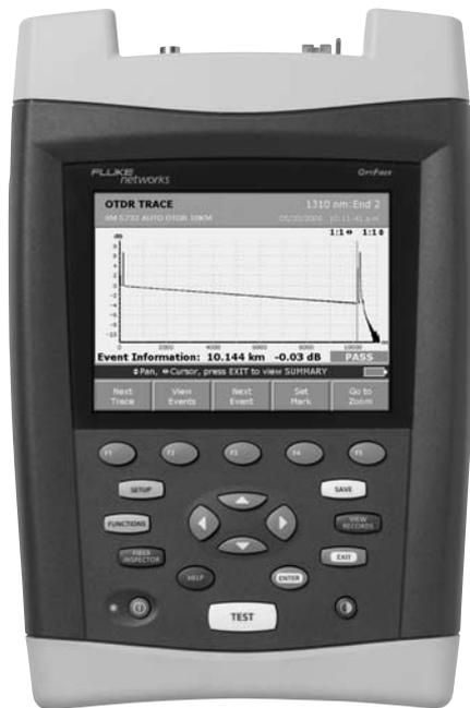
**OptiFiber – это сочетание мощной диагностики и возможности сертификации волоконно-оптических сетей в одном инструменте.**
