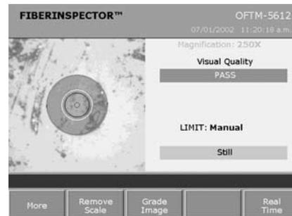
**FiberInspector:** Увеличенное изображение позволяет оценить качество полировки разъемов и определить проблемы низкокачественного подключения
