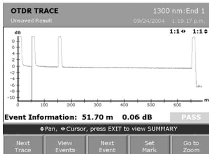
**Режим Авто:** Автоматический анализ рефлектограммы и событий облегчает тестирование с помощью оптического рефлектометра
