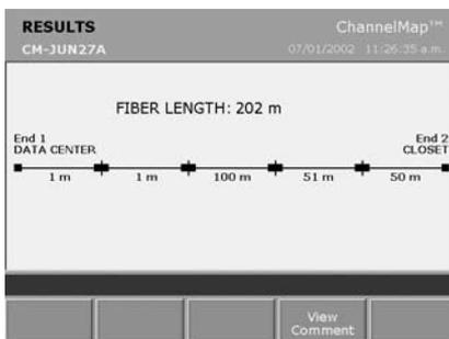
**ChannelMap:** Простая и легкая для понимания карта соединений в канале. Отображение всего канала с демонстрацией точек подключения коммутационных шнуров и расстояний до подключения
