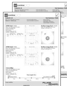
**LinkWare:** Приложение для управления и создания отчетов, включающих все выполненные измерения с помощью OptiFiber
