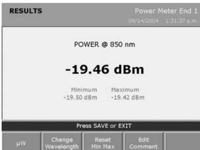
**Измеритель мощности:** Измерение оптической мощности для проверки производительности соединения и источника оптического излучения
